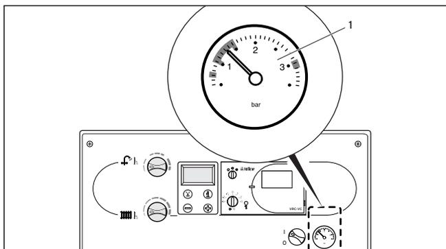
Fig. B.4: Controllare il livello dell'acqua dell'impianto
