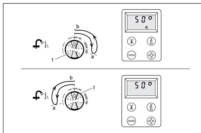
Fig. B.6: Attivazione e disattivazione avviamento a caldo
