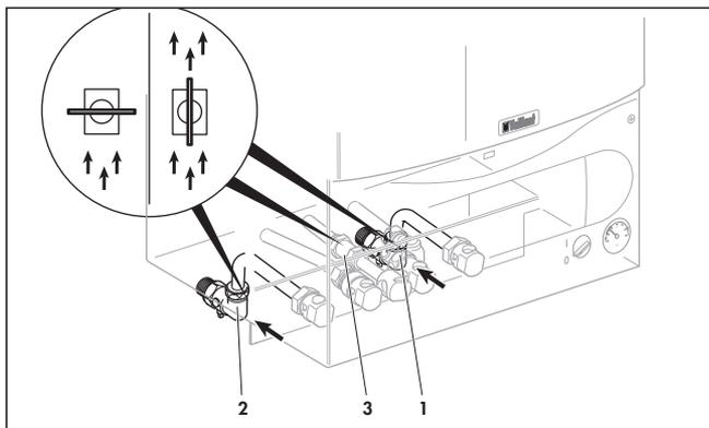
Fig. B.3: Aprire i dispositivi di intercettazione
