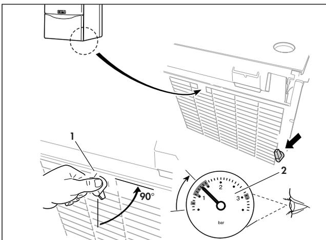
**Fig. B.15: Riempimento e svuotamento dell'apparecchio**
